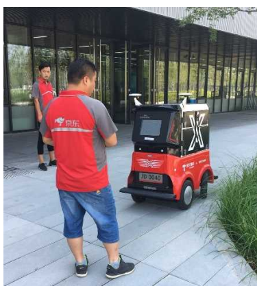
京東の移動式宅配ボックスは中関村でも実験が始まっている。携帯からの操作で開閉可能
