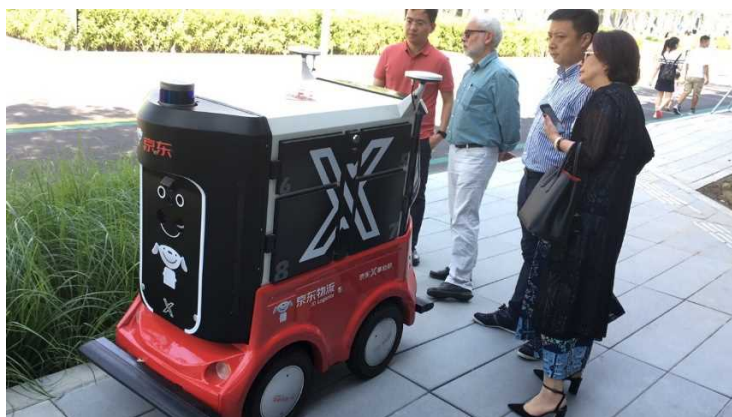
京東の移動式宅配ボックスは中関村でも実験が始まっている。携帯からの操作で開閉可能
