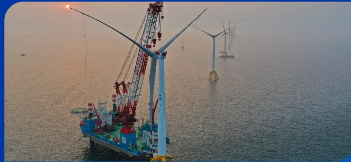
“白鹤滩号”第四代风电安装船 「白鶴灘号」第4世代風力発電設備設置船
