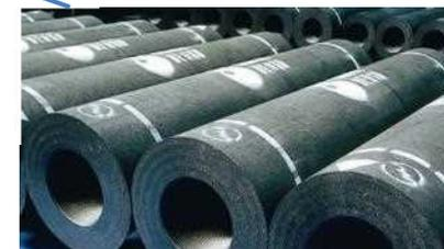
石墨电极（电炉制钢用电极）
