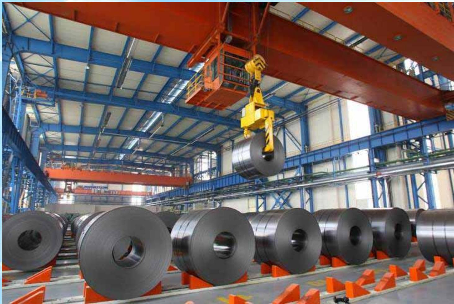
冷間圧延製品は薄鋼板規格を主体に、製品厚度0.25-2.0mm、幅700-1,600mmである。製品は主に、自動車鋼板、高級環保家電用鋼板、高級建築鋼板に利用。
