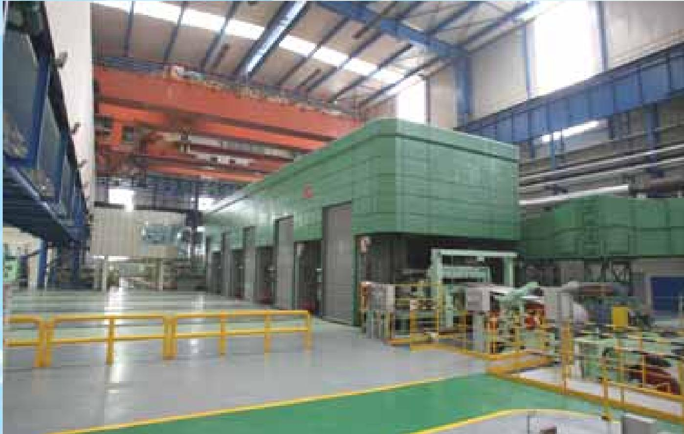
天津鞍鋼天鉄冷間圧延薄鋼板有限公司酸洗生産ラインは、2006年10月28日建設着工、2008年6月10日順調に稼働した。当該生産ラインはドイツSMS Siemag、ジーマンステクノロジーから導入し、設計年間生産能力は冷延巻150万t、2009年の生産量は97万tで生産量、品質ともに基準に達した。
