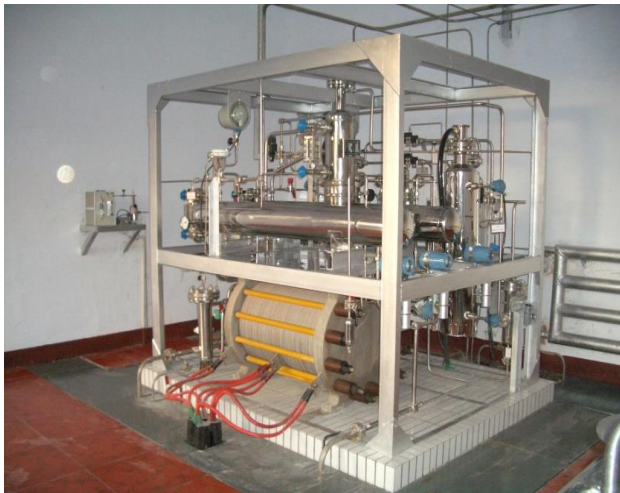
一体化式水电解制氢设备2200 x 1600 x 2000 (mm)
