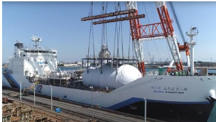
液氢储罐吊装 (2020/3/7)
